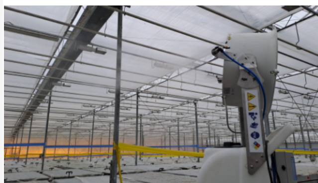
Przykładowe użycie zamgławiacza Unidoz w szklarni
